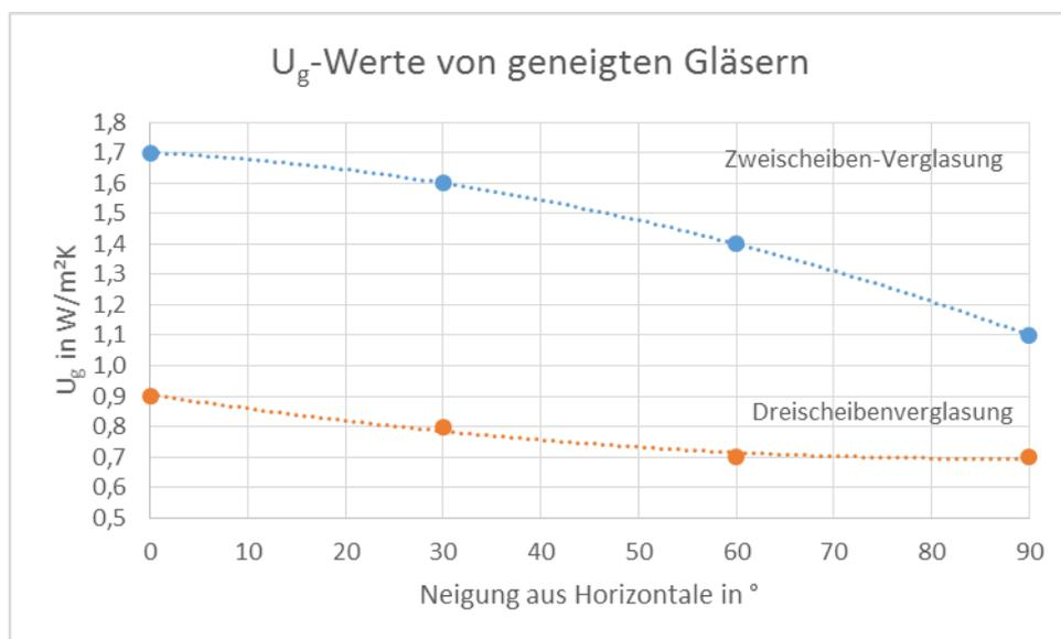
Diese Änderung des  $U_g$ -Wertes macht sich auch in den U-Werten von Glasdächern bemerkbar, wenn diese nicht wie Vertikalverglasungen behandelt werden.
