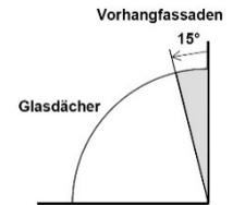
Während  $U_g$ -Werte von Gläsern,  $U_w$ -Werte von Fenstern (auch Dachflächenfenstern) und  $U_{CW}$ -Werte von Vorhangfassaden für den vertikalen Einbau deklariert (CE-Zeichen) und angewendet werden, kann die Angabe der U-Werte von Glasdächern für den geneigten Einbau erfolgen. Tatsächlich verändern sich die  $U_g$ -Werte der Gläser, wenn sie mit einem Neigungswinkel  $< 90^\circ$  zur Horizontalen eingesetzt werden.
